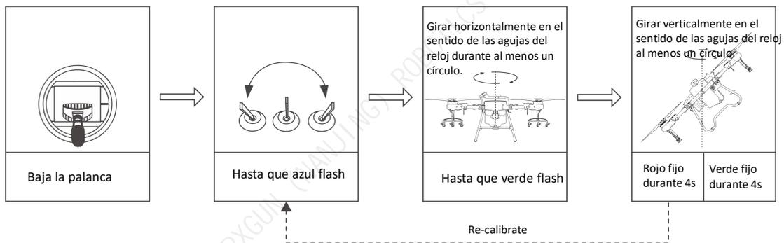
Figura 1 - 37 Calibración de la brújula
