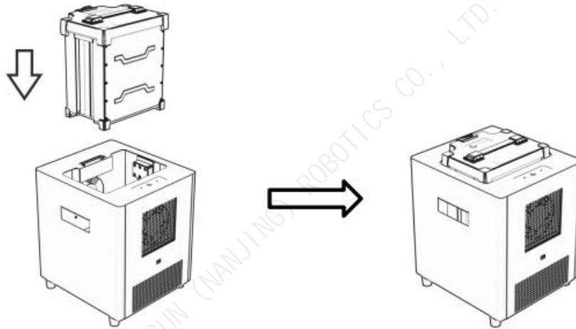
Figura 1 - 14 Colocación de la batería
