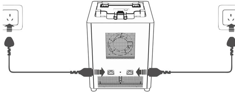
Figura 1 - 13 Conexión del cable de alimentación del cargador
