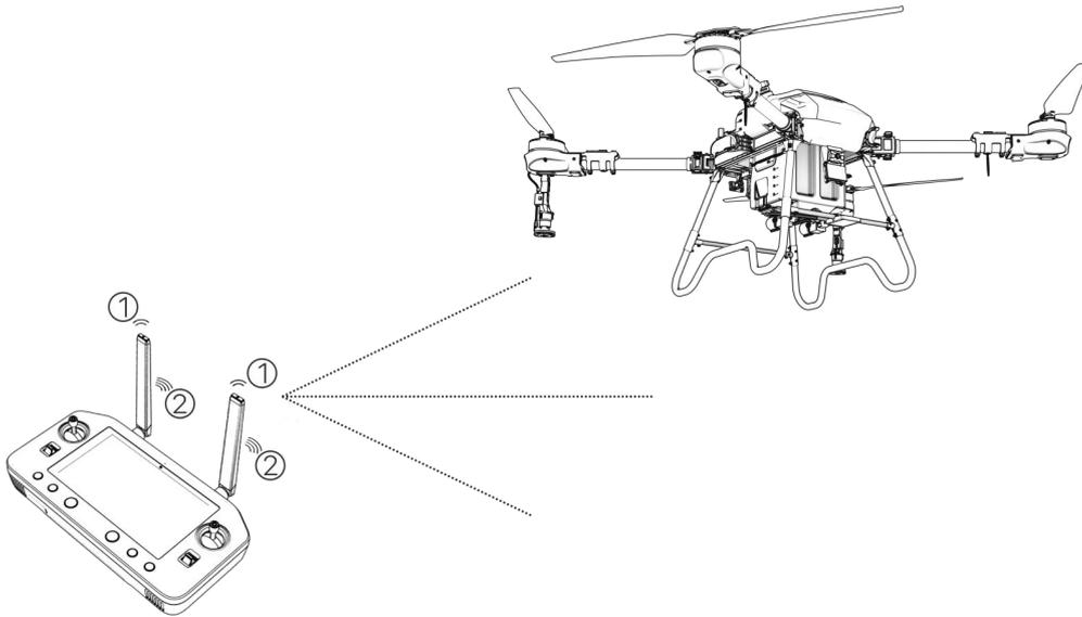
Figura 1-4 Intensidad de la señal del control remoto
