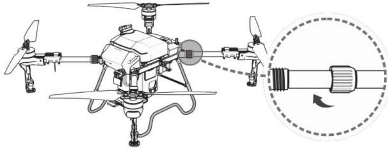
Figura 1 - 34 Proceso de fijación del brazo
